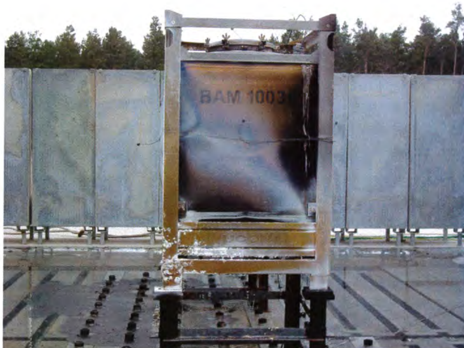
Bild 8 Ansicht des metallenen IBC nach dem Brandversuch
