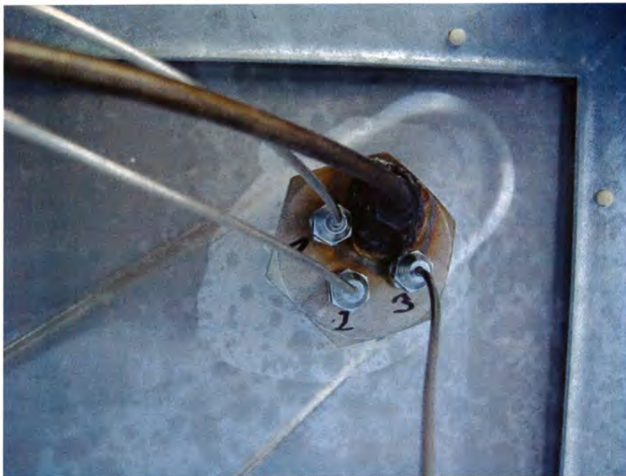
Bild 2 Verschlussstopfen des Behälters mit Durchführungen für Thermoelemente und Rohranschluss für die Druckmessung
