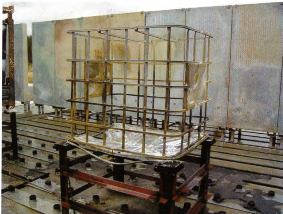
Bild 9 Ansicht des Rahmens des Kombinations-IBC nach dem Brandversuch
