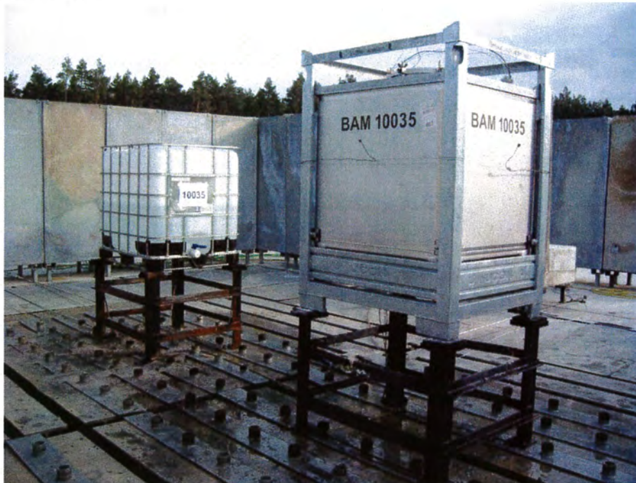
Bild 3 Ansicht der Prüflinge im Brandprüfstand
