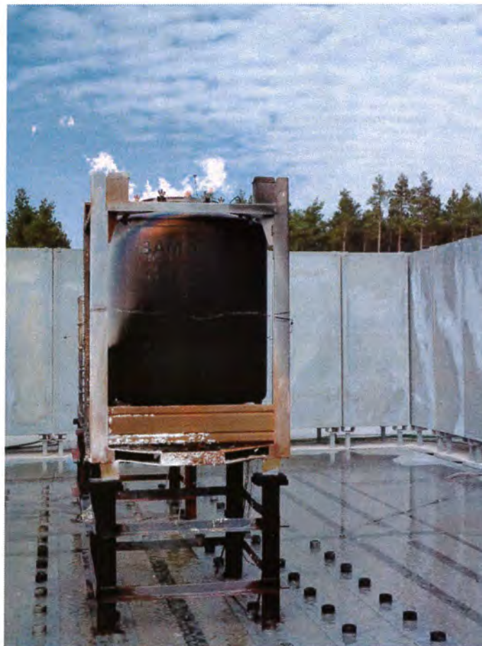
Bild 8 Ansicht des metallenen IBC nach dem Brandversuch
