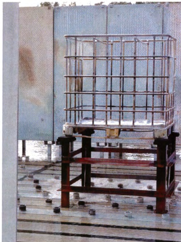
Bild 10 Ansicht des Rahmens des Kombinations-IBC nach dem Brandversuch
