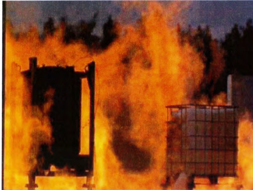
Bild 9 Ansicht des Kombinations-IBC kurz nach dem Schmelzen der Kunststoffblase
