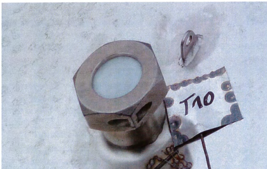
Bild 4 Ansicht der Schmelzsicherung des metallenen IBC auf dem Entlüftungsstutzen
