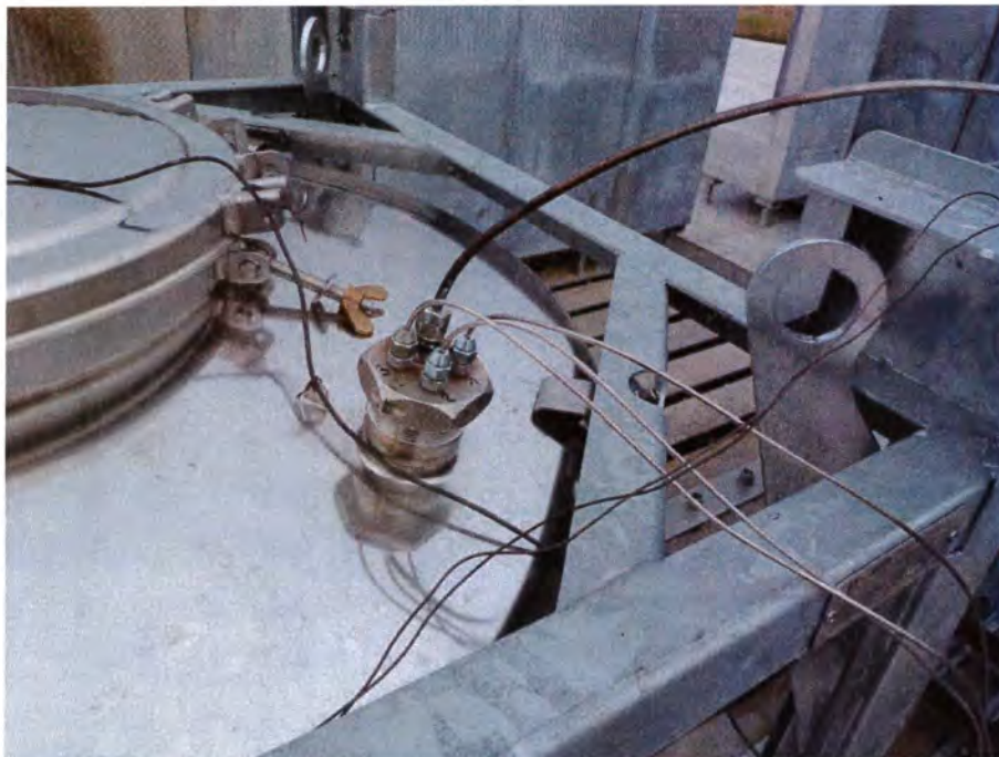
Bild 2 Verschlussstopfen des Behälters mit Durchführungen für Thermoelemente und Rohranschluss für die Druckmessung
