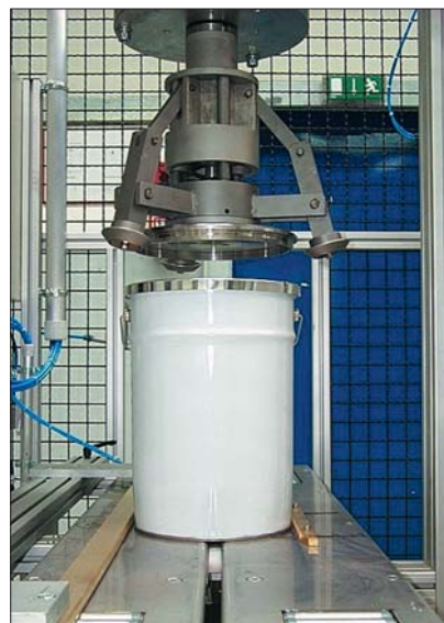
Automatische Deckelverschließanlage für Weißblechgebinde. (Foto: Muhr & Söhne GmbH & Co. KG)
